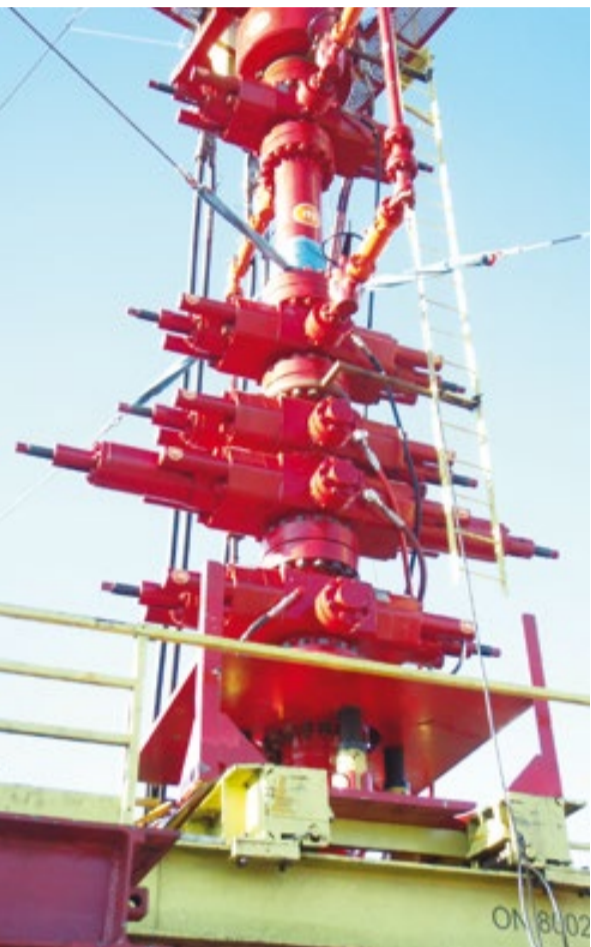
Sestava protierupčního zařízení a systém „snubbing unit“ soupravy HWO.
