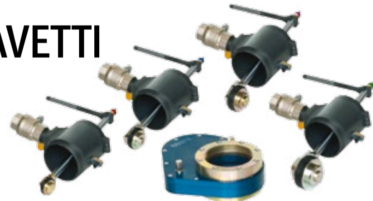
Planžetový uzávěr (modrý) a komory s uzavíracím pryžovým prvkem a bypasovou armaturou (v horní části komory je patrná páka pro rozpínání pryžového prvku)
